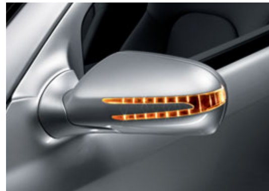
Der Außenspiegel mit integriertem LED-Blinker.
